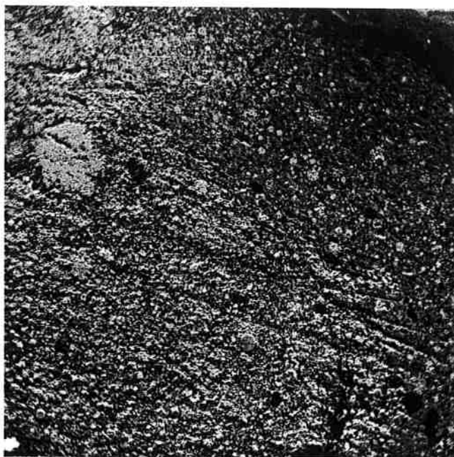
Figura 17 (MEV) - Pelota interrompida após etapa 2 do ciclo térmico ( 3' a 675 °C + 1' a 1200 °C + 1' a 1220 °C). Aumento de 19x e visão da interface entre a região reduzida e a não reduzida. (Perda de massa de 24,30%)
