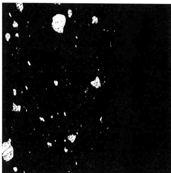
Figura 24 (Microscopia ótica) – Aumento de 50x da pelota que passou pelo ciclo térmico completo. É possível a observação de uma grande porosidade à direita da imagem. (Pouco visível).
